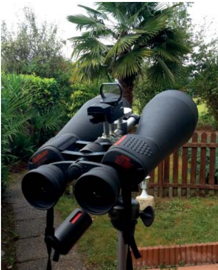
Jumelles astro 20x80 équipées d'un viseur point rouge de construction maison. © Dominique Machu
