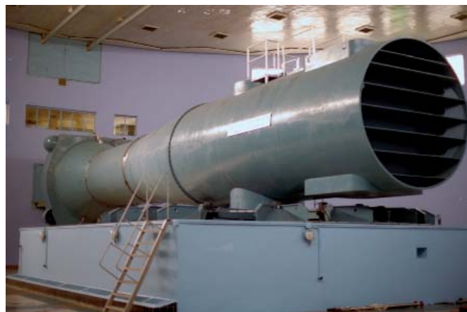
La centrifugeuse pouvant atteindre 30g. Pour donner une idée de l'engin, l'un des bras fait 18m de long.
