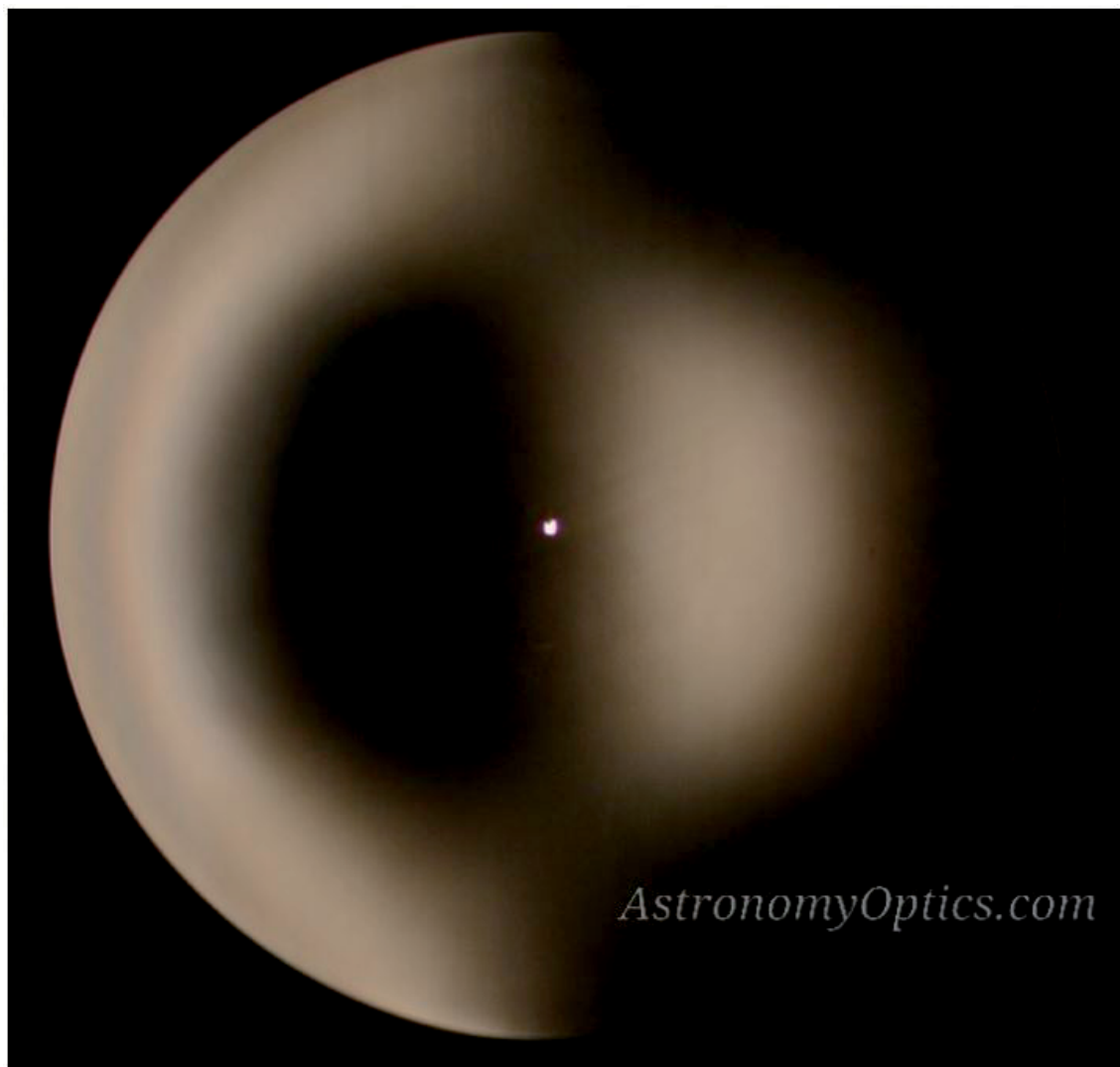
Figure 4: Miroir parabolique vu dans le test de Foucault. La source et la lame de couteau se trouvent au centre de courbure de la zone \sim 0,6 \times R_{\text{miroir}} . La lame est insérée du côté droit.
