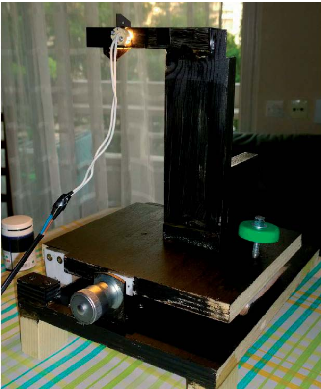
Figure 6: Testeur Foucault: à gauche on voit l'arrière du testeur (l'avant sera orienté vers le miroir) avec la vis micrométrique (grise) pour déplacer la source et le couteau en avant ou en arrière et une molette (verte) qui permet le déplacement à gauche et à droite (pour insérer le couteau). A droite on voit la fente (brillante) et le couteau (une des lames de la fente), ainsi que le rail sur lequel on déplace l'ensemble. Pour voir une image comme dans les figures précédentes, il faut placer l'oeil juste derrière le couteau et regarder le miroir.
