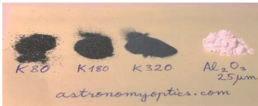
Quelques abrasifs : carbo #80, #180 et #320 et oxyde d'aluminium de 25 microns.
