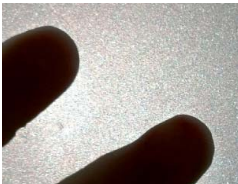
La surface rugueuse du verre après le travail avec du carbo #80 (doigts pour donner l'échelle).
