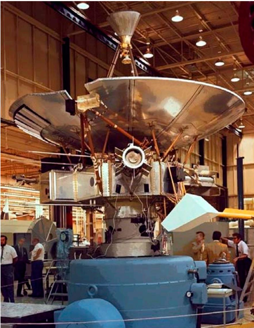
La sonde Pioneer 10 lors d'un test de robustesse aux vibrations.
