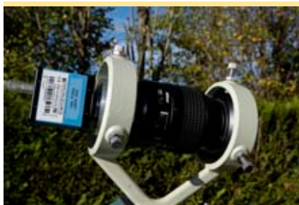
Chercheur électronique avec une DMK41AF02 et un objectif Nikon 135mm f/2,8
