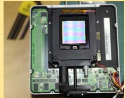
Vue sur le capteur KAF16803 et le capteur d'autoguidage (en-dessous). On y voit aussi le container à dessicant et la vis de mise au point du capteur d'autoguidage.
