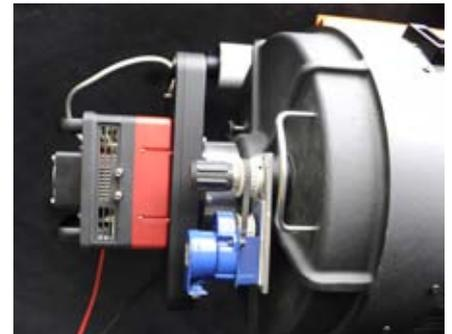
*La STX-16803 avec sa roue à filtres au foyer d'un C14*
