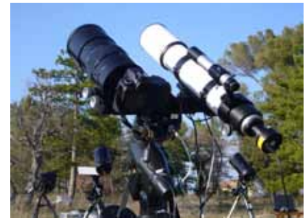
Autre exemple de montage : l'autoguidage se fait avec la lunette blanche équipée d'une webcam
