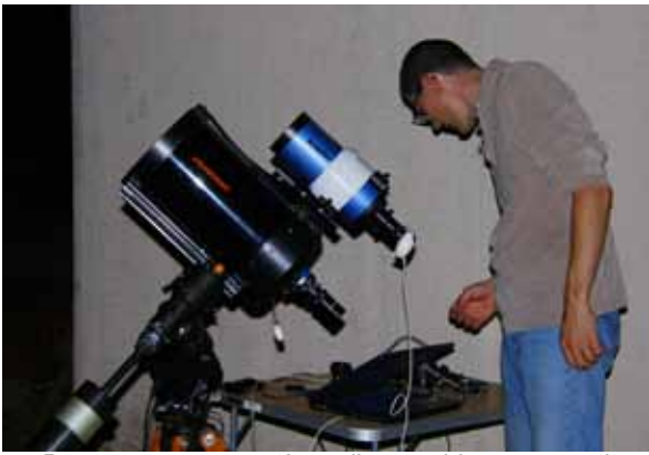
Bruno avec son système d'autoguidage : un petit Maksutov (en bleu) équipé d'une webcam en parallèle de son C8
