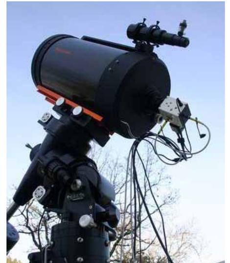
L'équipement d'Olivier Thizy (C11 sur Losmandy Titan). A l'arrière du télescope, la bonnette avec la fibre optique vers le spectro eShel.
