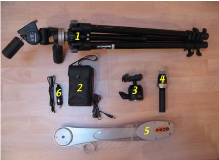
1) Trépied photo manfrotto 190B avec tête 141RC 2) pack d'alimentation 12V comprenant 8 piles LR20 d'1,5 volts 3) Rotule Manfrotto 486 RC2 4) viseur polaire Losmandy avec son adaptateur (bague alu) pour l'astrotrac 5) la monture Astrotrac TT320 6) Adaptateur allume cigare 12V livré avec la monture
