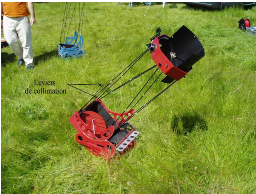
Un 250 «Voyage» avec ses leviers de collimation.
