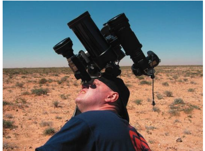
Olivier en plein préparatif avant la totalité: la monture équatoriale supportant le NIKON D100 avec optique de 400mm, un caméscope DV ainsi qu'un ETX 90 pour faire un peu de visuel.
