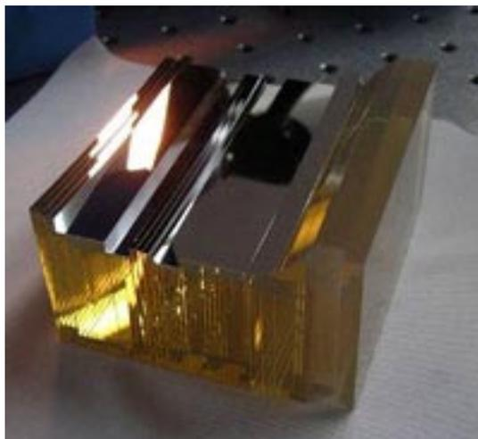
*Un slicer, dispositif optique permettant de « découper » le champ*
