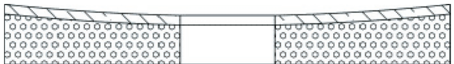
Les Clavius 254 et 460 sont équipés de Miroirs Composites Carbone: la céramique (densité 3) s'appuie sur un support composite carbone à cellules ouvertes (d'une densité inférieure à 0,5) ayant les mêmes propriétés thermiques qu'elle.
