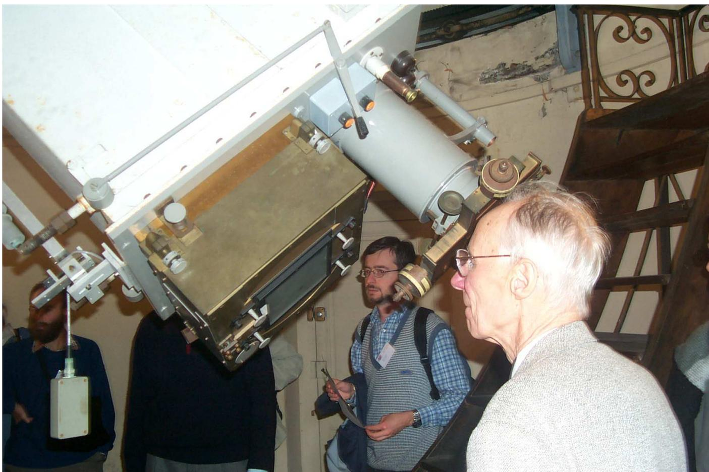
Sur le site de l'Observatoire, une petite coupole abrite l'équatorial de la Carte du Ciel construit par Gautier sur une monture à berceau. L'équatorial comprend deux lunettes accolées: l'une, photographique, est munie d'un objectif de 33cm de diamètre et 3.43m de focale; l'autre, visuelle, sert au pointage et au suivi. Les deux objectifs ont été taillés par les frères Henry. Mis en service en
