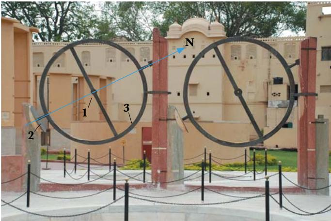
Le Chakra Yantra : (1) Centre des anneaux permettant d'insérer un tube de visé. (2) Plaque circulaire gravées permettant de déterminer l'angle horaire. (3) Anneaux en laiton sur lesquelles des gravures sont inscrites. Elles forment une échelle de 360 degrés divisés en 10 subdivisions permettant de déterminer la déclinaison d'un objet céleste. Photo : assets.traveltriangle.com
