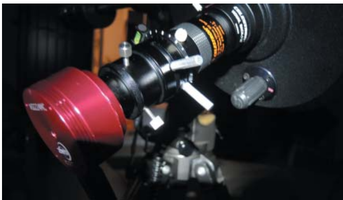
A l'arrière du télescope, avant la caméra, on peut voir une barlow x2,5 et un correcteur de dispersion atmosphérique (ADC). © Claude DEBARD
