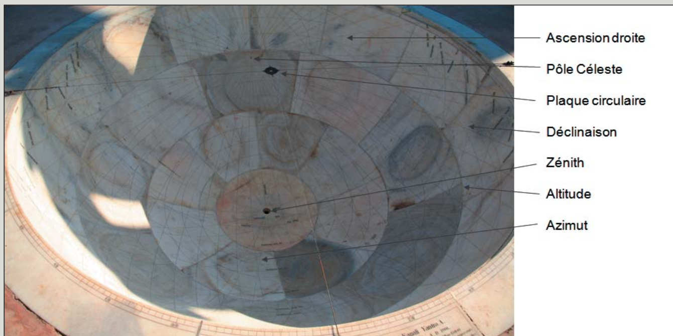
Photo de l'un des hémisphères du Kapali Yantra. On y voit, gravés, les deux systèmes de coordonnées (azimutal équatorial). L'ombre projetée de la plaque circulaire, suspendue par deux câbles, indique les coordonnées du Soleil. Source Wikipédia, annotations Mathilde SILVESTRE
