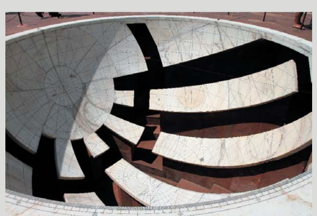
L'un des deux scaphées du Jai Prakash Yantra. On y voit sa structure en segments gravés des coordonnées azimutales et équatoriales. Entre les segments, l'observateur se positionnait pour lire les coordonnées de l'astre aligné avec la plaque percée suspendue au-dessus de l'hémisphère. Source web
