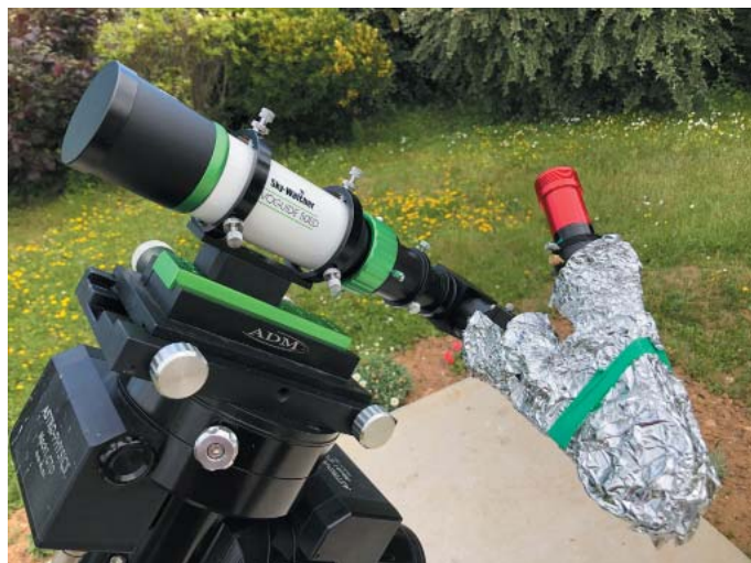
Le Sol'Ex de Vincent est ici monté sur la lunette et emballé dans du papier aluminium pour le protéger de la chaleur @Vincent LECOCQ
