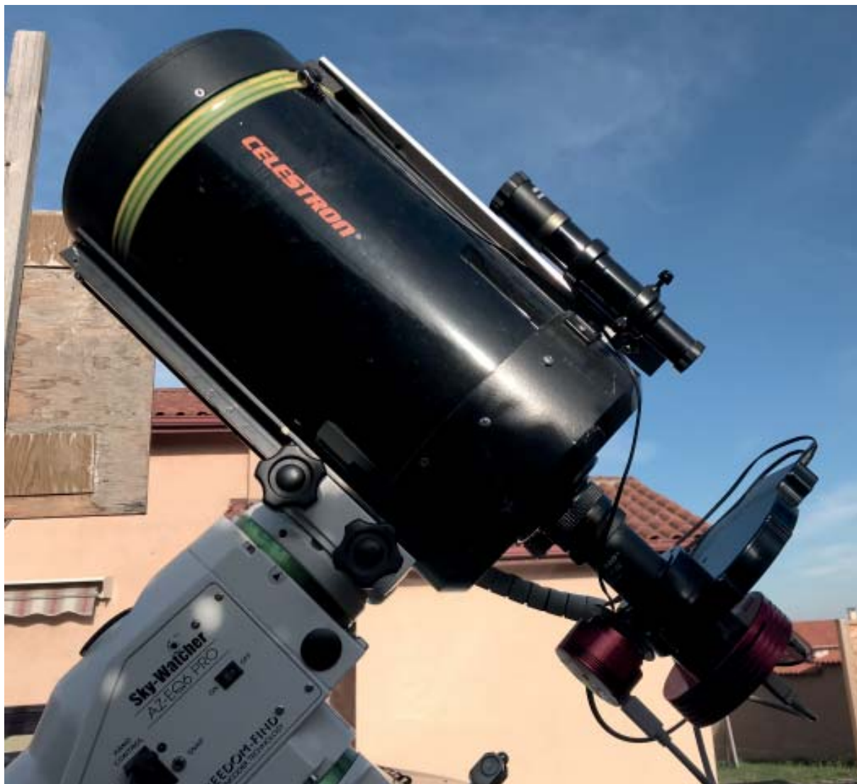
Le guidage hors-axe consiste à utiliser un diviseur optique qui "dévie" une partie du flux lumineux issu du télescope vers la caméra de guidage. Sur l'image ci-dessus, le diviseur est placé juste avant la roue à filtre et le guidage s'effectue avec la petite caméra rouge placée en-dessous. © Bruno CHRISTMANN
