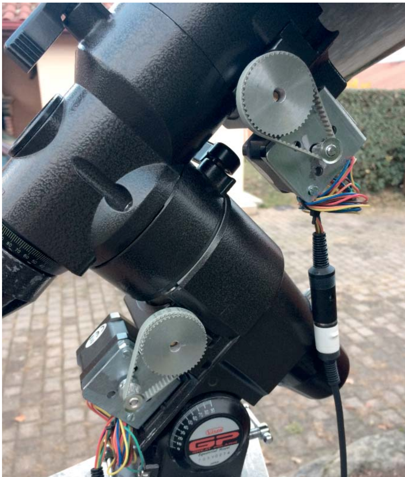
Monture GP modifiée avec moteurs 400 pas par tour et poulies / courroies avec rapport de réduction 4:1 - © Bruno CHRISTMANN
