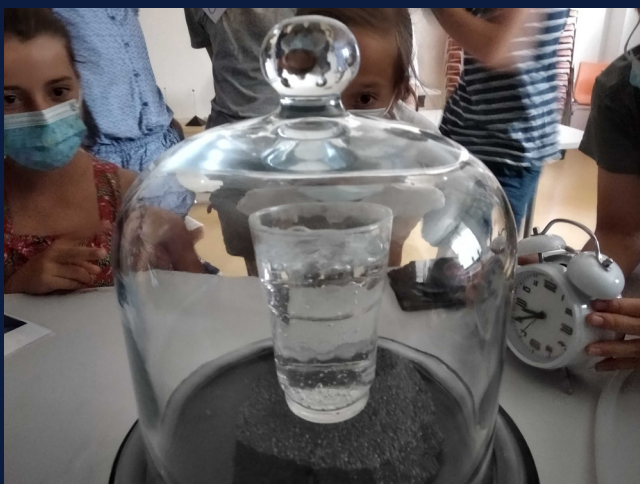
État de l'eau dans une pompe à vide
